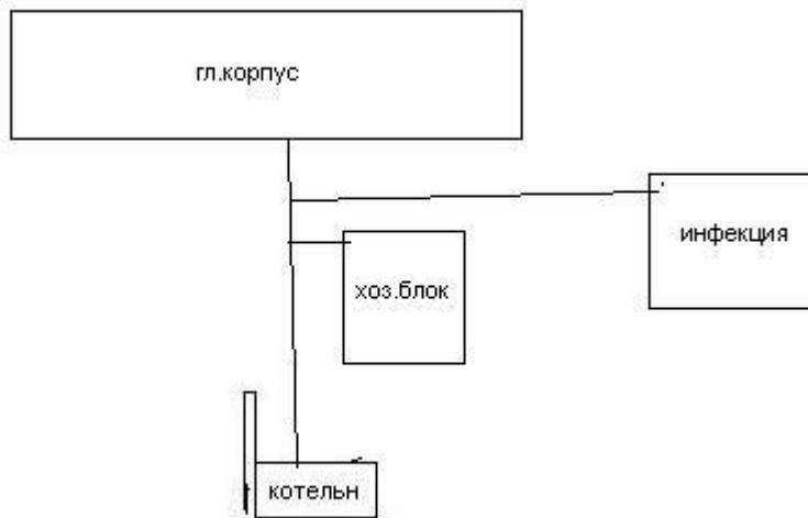
Рис. 2.3.5. Схема тепловой сети котельной №5 Больничная с. Крутиха
