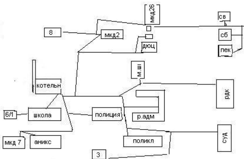
Рис. 2.3.2. Схема тепловой сети котельной №2 Центральная с. Крутиха
