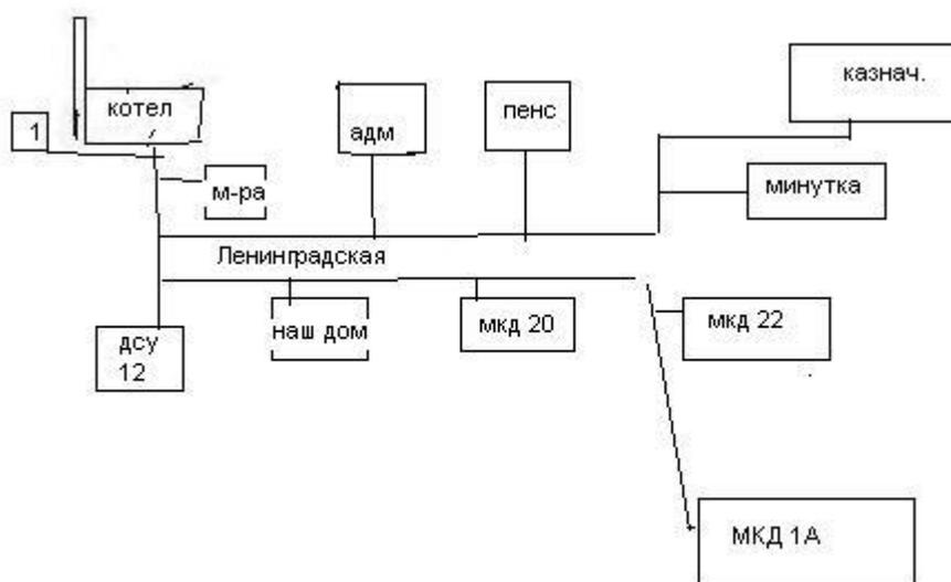
Рис. 2.3.3. Схема тепловой сети котельной №3 Райповская с. Крутиха
